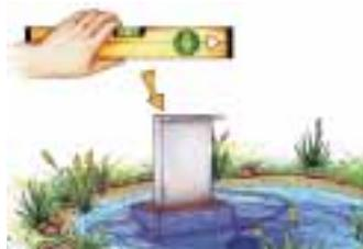
Pour obtenir une chute d'eau parfaitement droite, il est indispensable de contrôler l'horizontalité du montage. Servez-vous d'un niveau à bulle à cet effet.
