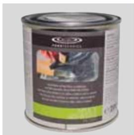
Colle noire (butyle) pour coller EPDM (bâche ou Form Flash) sur EPDM ou métal ou polyester (à utiliser après application de Splice Wash) – quantité 1 litre par 4 m<sup>2</sup> (= total pour les 2 côtés). Appliquer sur les deux côtés.
