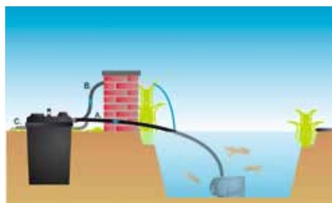
Filtre à pression: mise à terre partielle: tuyau d'alimentation (A), tuyau de retour (B) et tuyau d'évacuation des eaux usées (C)
