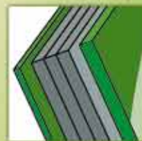
Résistance garantie et éprouvée dans le temps (fibre de verre + topcoat + gelcoat).
